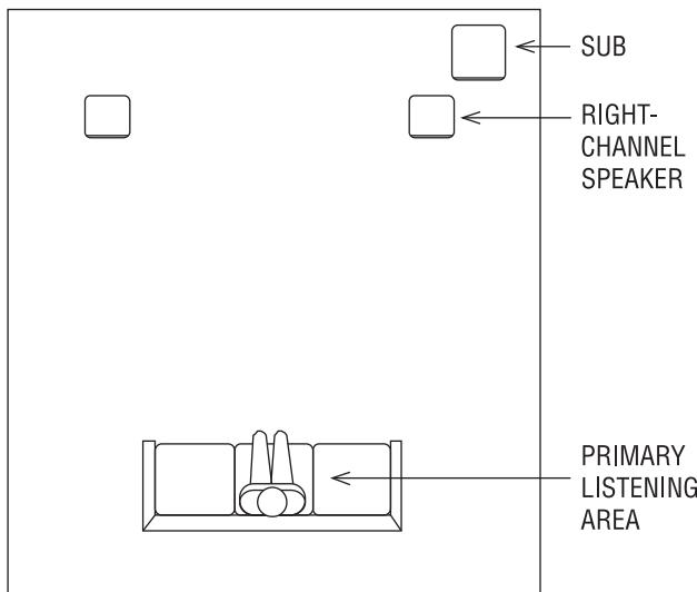
Рис.1. На этом примере показано размещение сабвуфера позади сателлитной АС правого канала для воссоздания реального размещения басовых инструментов в оркестре и/или придания динаминости фонограммам фильмов.
